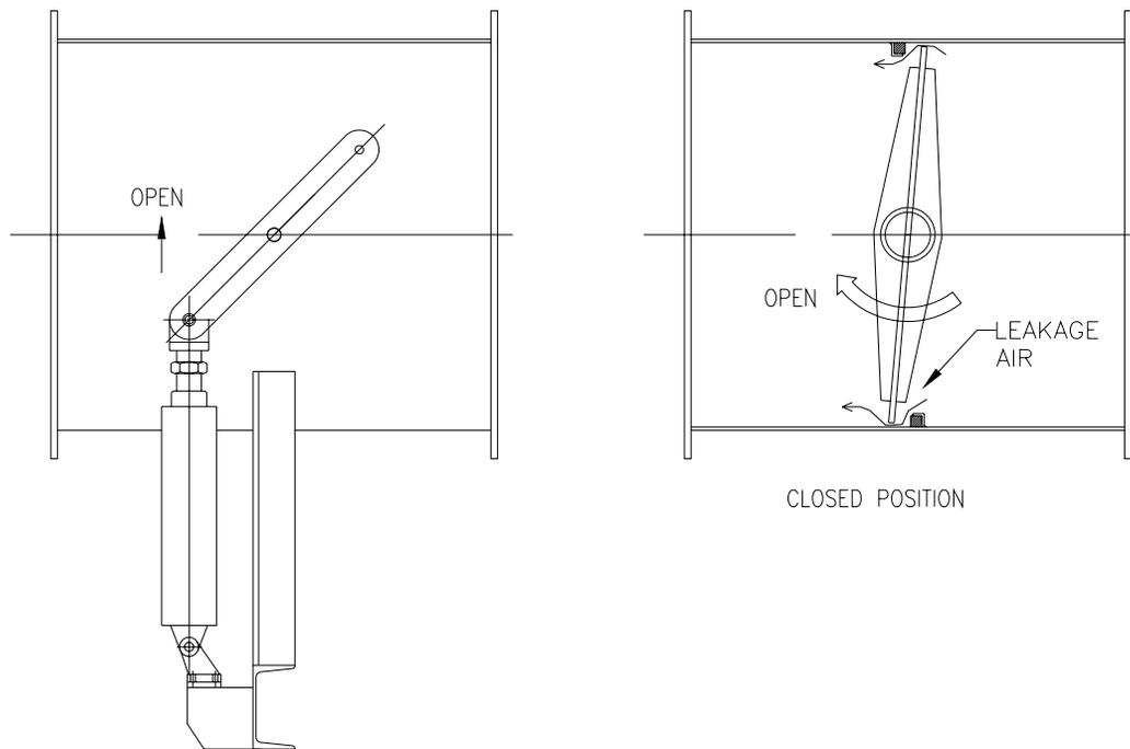
FIGURE10 : IMPROPER POWER CYLINDER ERECTION CAUSES LEAKAGE
