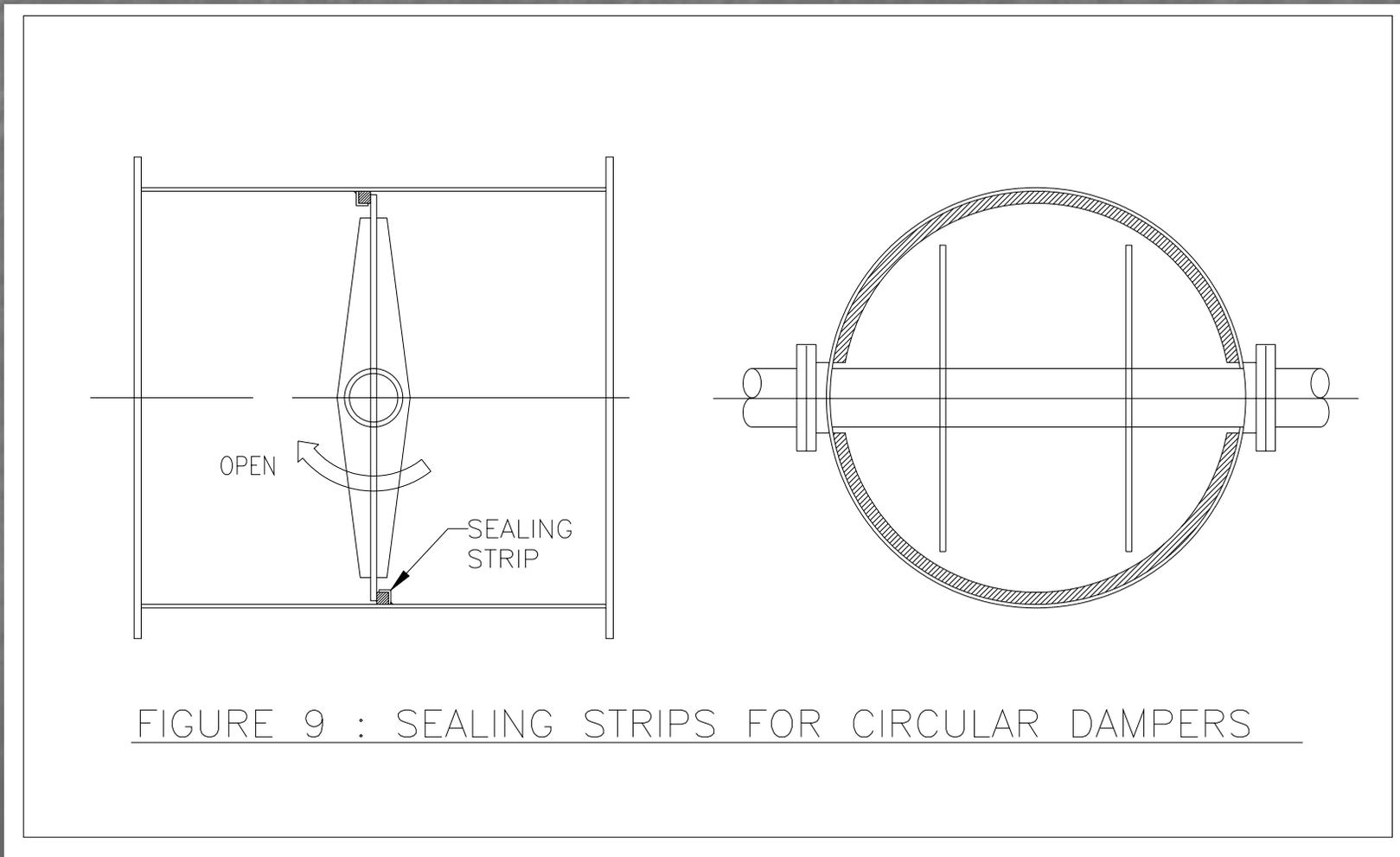
FIGURE 9 : SEALING STRIPS FOR CIRCULAR DAMPERS
